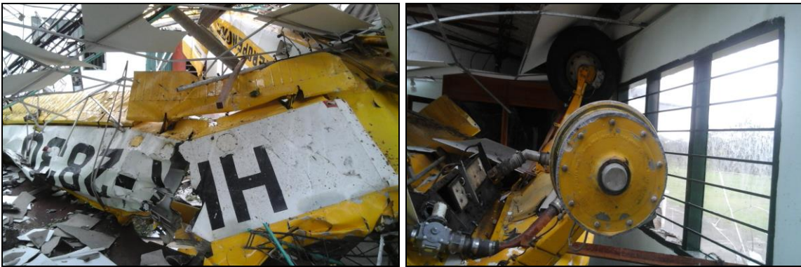
Fractura plano izquierdo (Izq.) y estado final tren de aterrizaje delantero (Der.)
