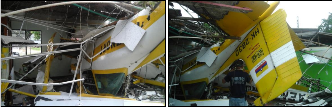
Daños estructurales fuselaje y plano derecho (Izq.) y condición del empenaje (Der.)
